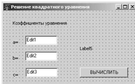
Рис. 3.19. Конструирование формы для решения квадратного уравнения
